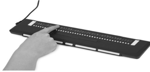
شكل 13 جهاز ALVA وهو عارض برايل من إنتاج شركة Optelec 3
