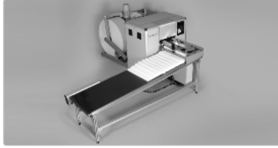
شكل 10 جهاز Braillo لطباعة وإنتاج مطبوعات برايل في مؤسسات النشر 1
