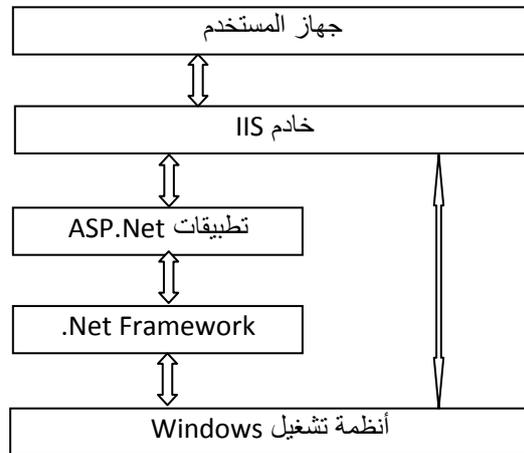
بدايةً قبل التبحر في تفاصيل أكثر تعقيداً , الرسم الذى أمامك يمثل الشكل البسيط لبيئة العمل , ولكن يمكن أن يدور الحديث عنه من جهتين , الجهة الأولى , انه رسم توضيحي لمتطلبات العمل لإنشاء وتطوير تطبيقات ASP. Net . و الجهة الأخرى , أن هذا الشكل يمثل موقعك بعد النشر .
