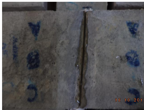
شكل 4-15 اختبار علاج الشقوق المكون من ( سيليكيا+ معلق بكتيري)
