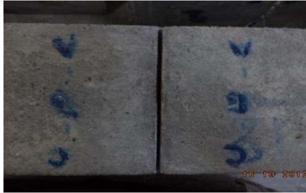
(شكل 3-3 يوضح الشكل خرسانة ذات شق واحد بعرض 2ملم)
