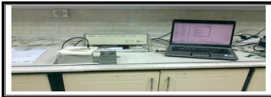
الشكل (3-5) صورة فوتوغرافية للجهاز المستخدم في قياس تأثير هول.
