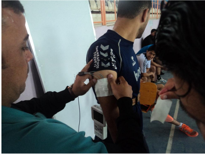
شكل ( 11 ) يوضح تثبيت جهاز ولاقطات تسجيل النشاط الكهربائي على ذراع اللاعب
