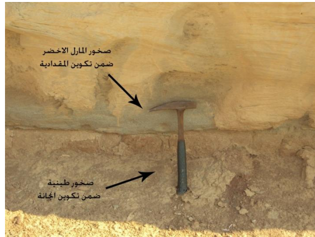
صورة رقم (2 - 1) تكوين انجانة حيث يمكن مشاهدة منطقة التماس بين تكوين انجانة ذات الصخور الطينية في اسفل الصورة وتكوين المقدادية ذات صخور المارل الاخضر في اعلى الصورة. تقع الظاهرة الى الجانب الغربي من سد حميرين
