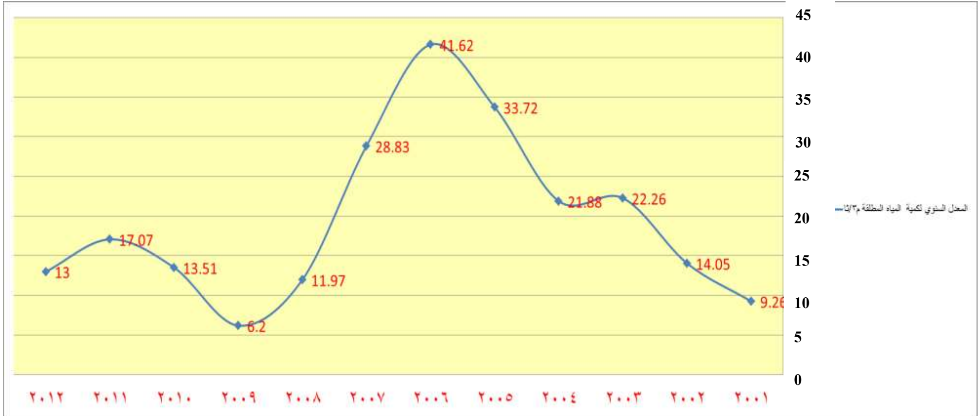
شكل (11) يوضح معدلات التصاريح الشهرية والسنوية م3/ثا المطلقة من مؤخر السد العظيم (م3/ثا) للمدة 2001-2012.
