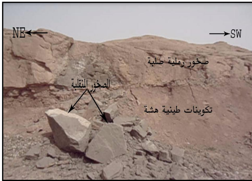
صورة رقم (٢- ١٥) ظاهرة الانقلاب الصخري. تقع الظاهرة في المحطة السادسة بالقرب من منطقة سهينة تاريخ التصوير ٢٠١٢/٤/٢
