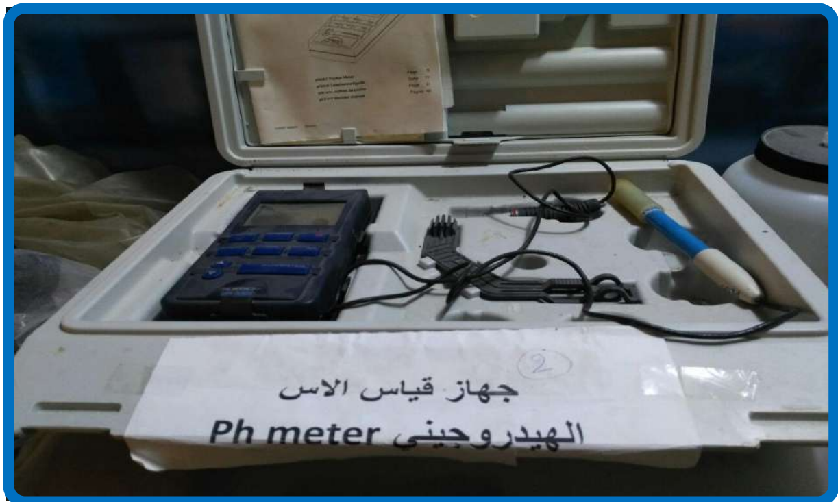
جهاز قياس الأس الهيدروجيني (Ph meter) - مختبر الحيوان
