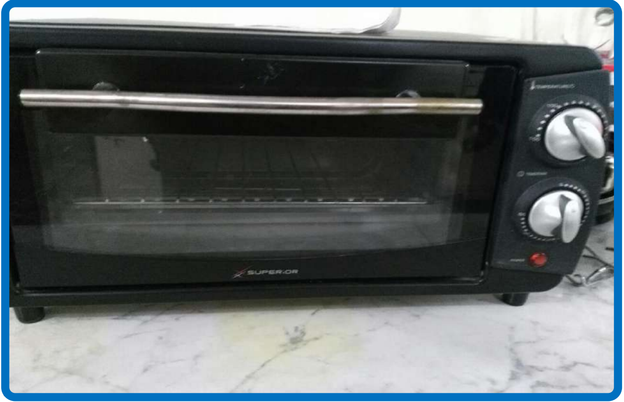
فرن كهربائي لتجفيف الأدوات الزجاجية وبعض المواد الكيميائية - مختبر النبات
