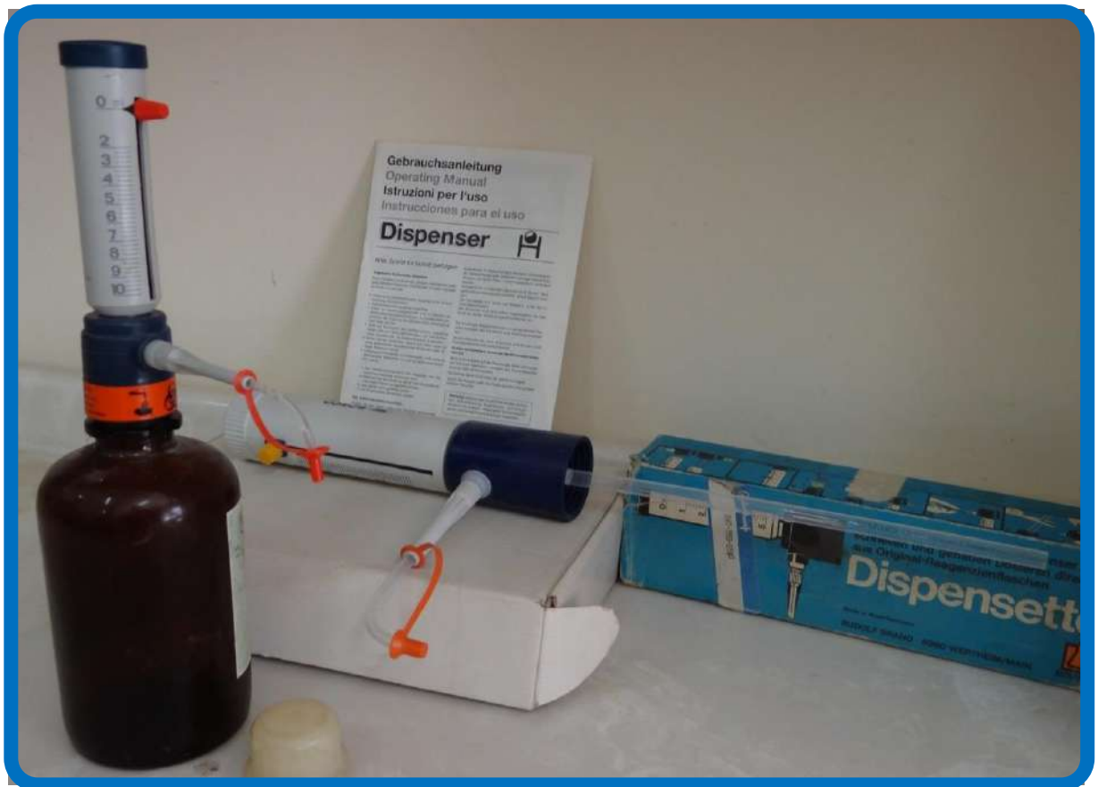
جهاز قياس حجم السوائل (Dispenser) - مختبر الكيمياء التحليلية
