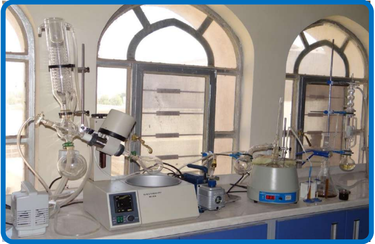
جهاز المبخر الدوار لفصل السوائل الملتزجة - مختبر الكيمياء الفيزيائية
