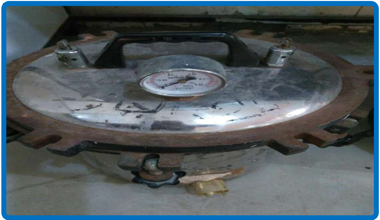
جهاز اوتو كليف (التعقيم بالضغط) لتعقيم الأدوات والأوساط الزرعية - مختبر الفطريات
