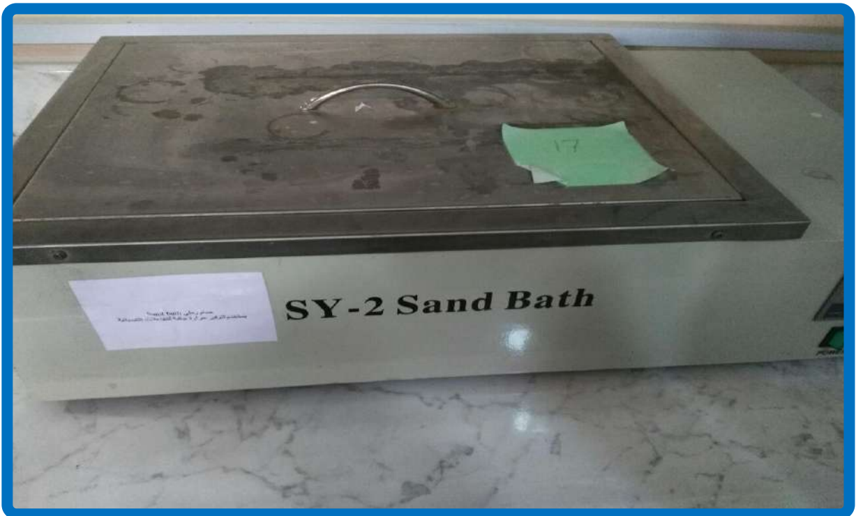
حمام رملي يستعمل لتوفير حرارة جافية للتفاعلات الكيميائية- مختبر النبات
