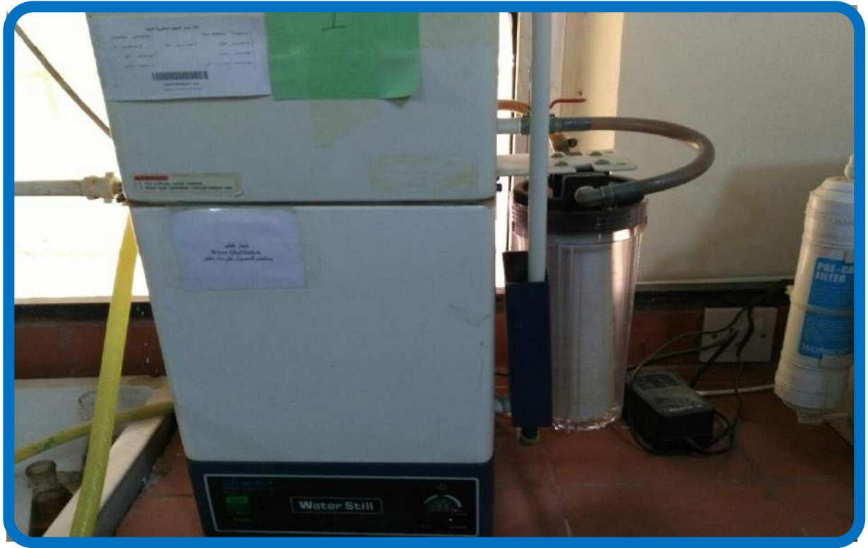
جهاز تقطير يستعمل للحصول على الماء المقطر - مختبر النبات
