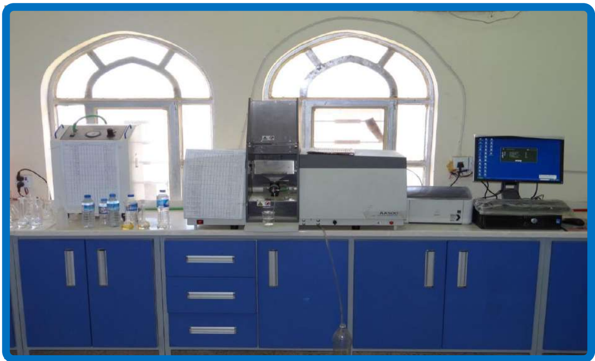
جهاز المطياف الذري (الامتصاص الذري) يستعمل لقياس تراكيز العناصر الفلزية -
