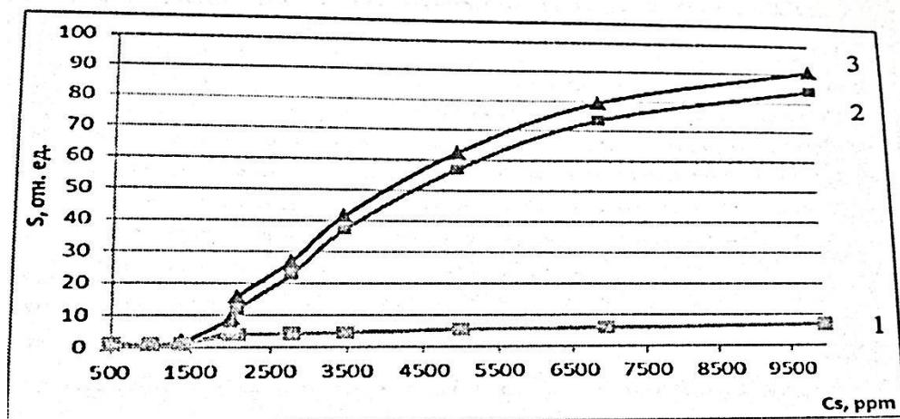
كما موضح في الشكل رقم ١ فان اعتمادية الاستشعار الغازي للمعدن هي ٦٠٠٠ لتكون الصيغة بالشكل التالي  $\text{AgNO}_3$  لاجهة الاستشعار الكهربائي من درجة تركيز ابخرة الغاز في الهواء عند  $T = 21^\circ\text{C}$  لمحلول الامونيا المائي ، والامونيا النقي والماء .
