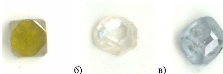
Рисунок 1 – Монокристаллы алмаза: а) типа Ib, масса 0,125 ст, б) типа IIa, масса 0,165 ст, в) типа IIb, масса 0,075 ст
