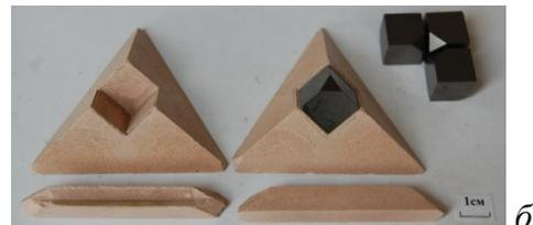
Рис. 9. Пуансоны и контейнер третьей ступени АДВ типов 6–8–6 (а) и 6–8–8 (б).
