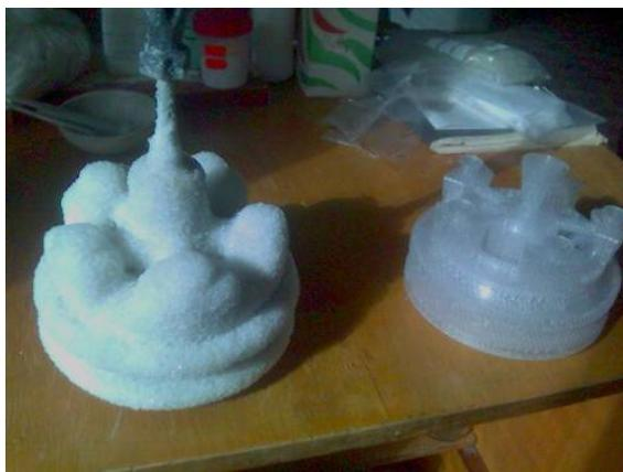
Рисунок 2 – Внешний вид оболочковой формы и полимерной модели гидротурбины.
