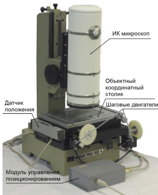
Рисунок 1– Сканирующий инфракрасный микроскоп
