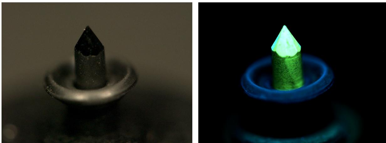
Рисунок 1 – Оптическое изображение (слева) и картина фотолуминесцентного свечения заготовки острия зонда СТМ из полупроводникового монокристалла алмаза
