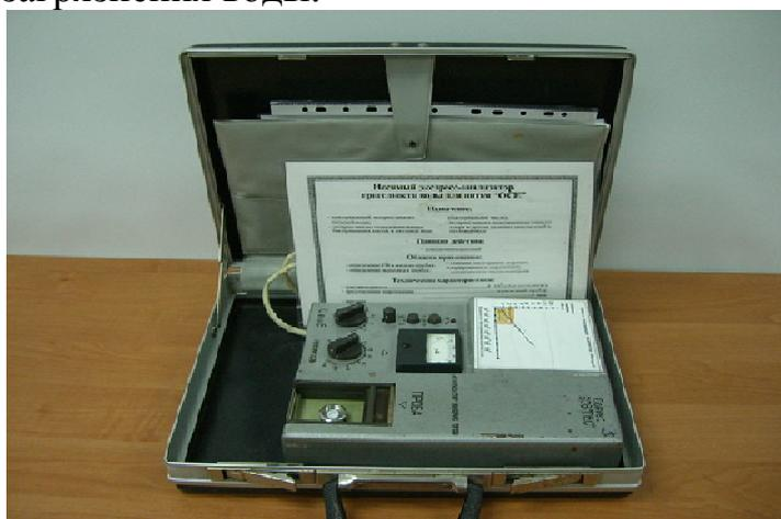
Рис.1. Экспресс-анализатор жидких сред (ОСЕ-2)
